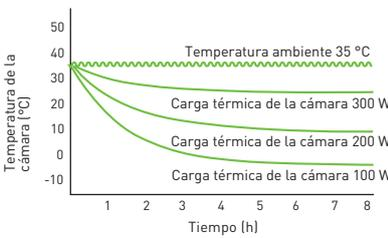
\*Los datos que se muestran arriba se obtienen con la lámpara fluorescente apagada.
