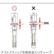
にまっすぐにゆっくりと挿入します。 **チューブとテストスティックの接合部 に隙間ができないようにしっかりと** 差し込みます。
